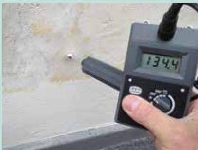
Eksempel på opstigende grundfugt indvendig i kælder.
