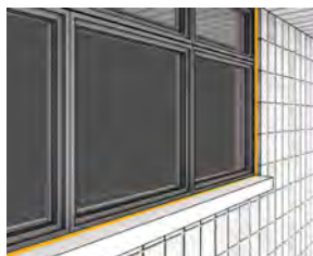
Fugning omkring vinduer.
